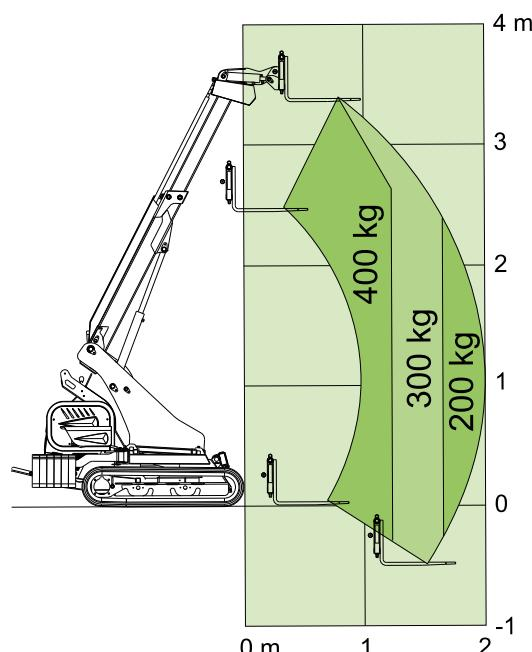
Bei ausgefahrenem Teleskoparm beträgt die maximale Tragfähigkeit des Handler 400 ganze 400 kg (einschließlich Lastgabeln). Das Anbaugerät ist mit einem Kippschutzsystem ausgestattet, das dem Bediener maximale Sicherheit gewährt.
