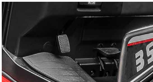
Pedalbediente Feststellbremse auf Wunsch
